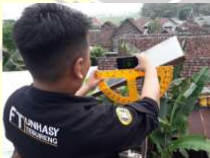
Gambar 6 Mengatur sudut kemiringan panel surya
