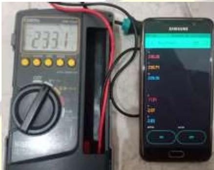
Gambar 15. Tampilan Nilai Tegangan Fasa S Motor I pada AVOMeter dan Blynk
