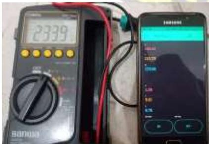
Gambar 11. Tampilan Nilai Tegangan Fasa R Motor I pada AVOMeter dan *Blynk*
