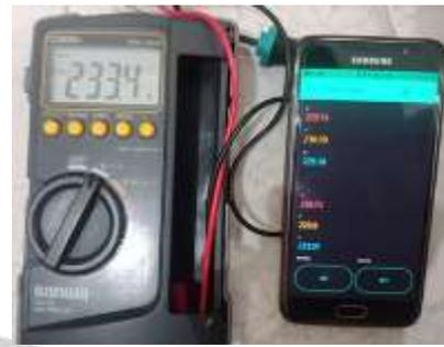
Gambar 12. Tampilan Nilai Tegangan Fasa R Motor II pada AVOMeter dan *Blynk*
