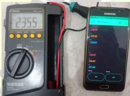
Gambar 16. Tampilan Nilai Tegangan Fasa S Motor II pada AVOMeter dan Blynk
