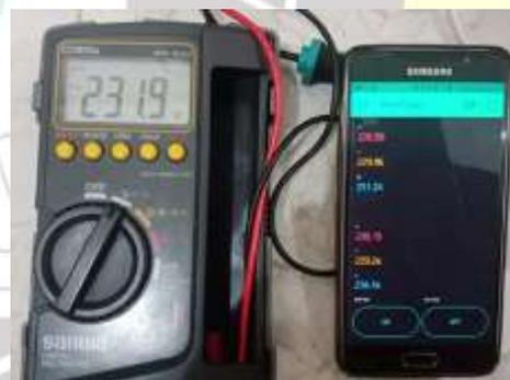
Gambar 19. Tampilan Nilai Tegangan Fasa T Motor I pada AVOMeter dan Blynk.
