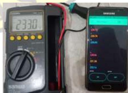
Gambar 20. Tampilan Nilai Tegangan Fasa T Motor II pada AVOMeter dan Blynk.
