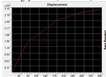
**Gambar 4. Kurva Kapasitas X**
