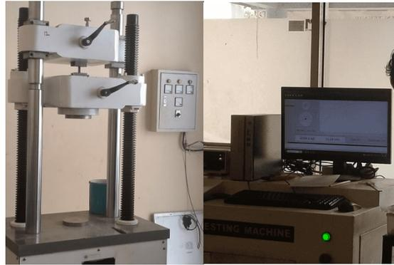
Gambar 3 Mesin UTM yang Connect ke computer
