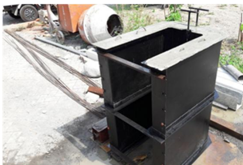
Gambar 1. Molen dan Cetakan U-ditch dari Material Baja
