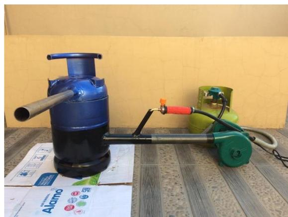
Gambar 8. Crucible Furnace Berbahan Bakar Gas Dilengkapi dengan Blower
