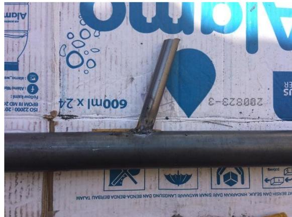
Gambar 4. Pipa Saluran Blower dan Gas LPG
