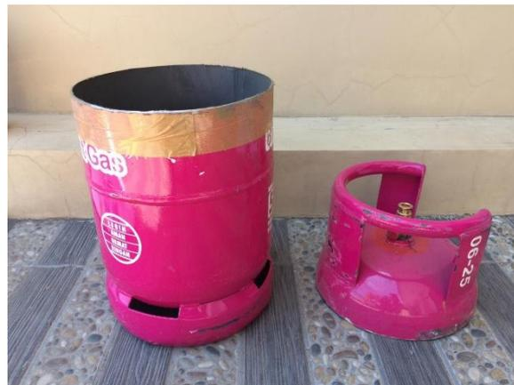
Gambar 3. Badan dan Penutup Furnace dari Tabung Gas LPG
