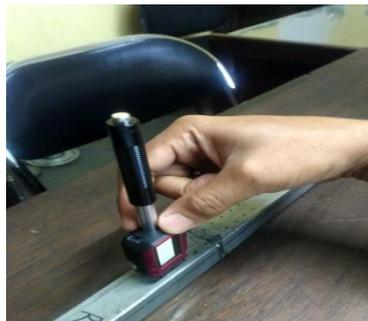
Gambar 9. Pengujian Brinell (HRB)
