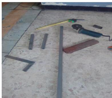
Gambar 4 : Pemotongan besi hollow
