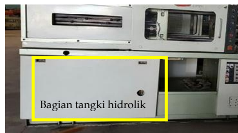
Gambar 3.2 Tangki Hidrolik di Mesin Injection Moulding
